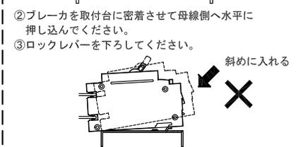
注意 ブレーカの溝に取付板の突起がはまっていない状態でブレーカを取り付けると、ブレーカが破損するおそれがあります。
