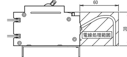
接続電線は、電線処理範囲内で適当な余裕をとって配線してください。
