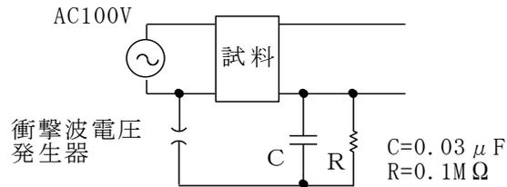
(衝撃波電圧発生器：ノイズ研究所製LSS-712B型)
