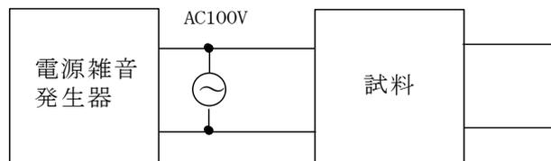
(電源雑音発生器：ノイズ研究所製INS-420型)
