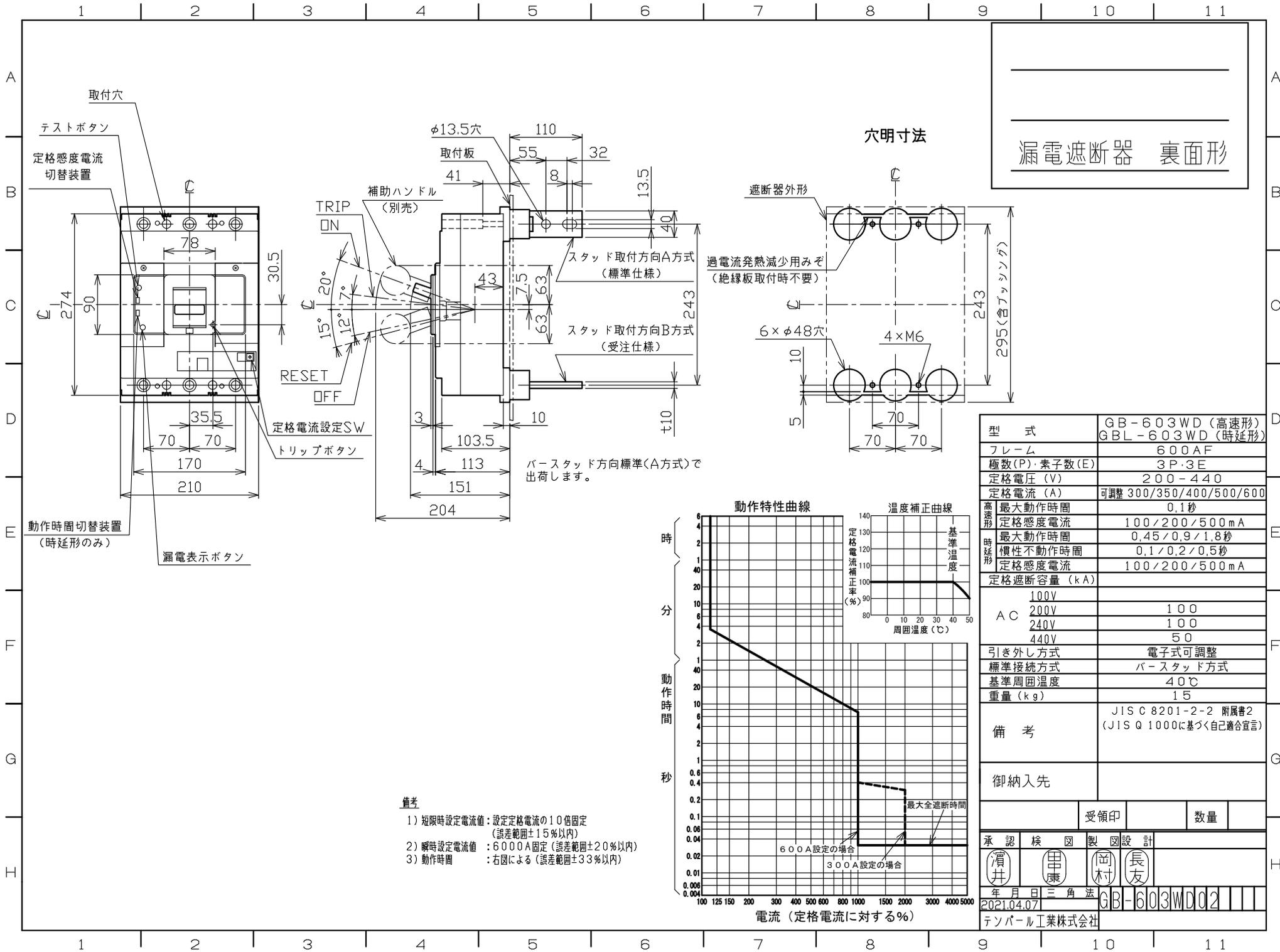
漏電遮断器 裏面形
