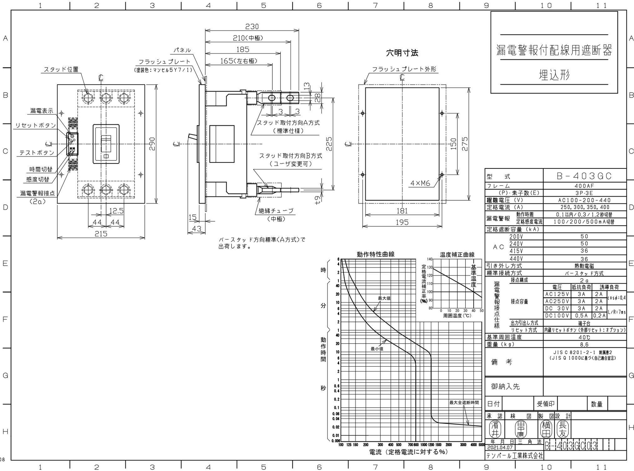
漏電警報付配線用遮断器
