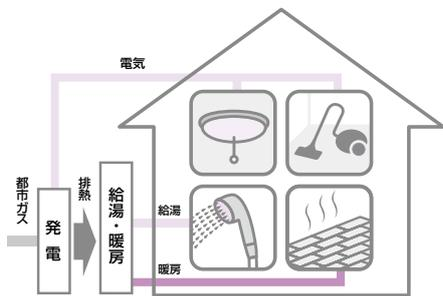
ガス発電・給湯暖房機のしくみと熱の利用先
