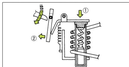
大電流がコイルに流れた場合は、可動鉄心の動きをままたす。①瞬時に作動鉄片が吸引され②作動板を動かします。
