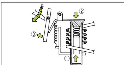
①過電流がコイルに流れると可動鉄心が固定鉄心の方へ吸引されます。②吸引されると磁気抵抗が減少し作動鉄片が吸引され作動板を動かし③開閉機構部の係合端が外れ、これに連動し可動接点が開き回路を遮断します。
