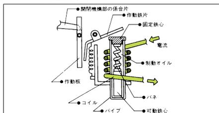
構造は図のようにパイプにコイルが巻かれており、このコイルに電流が流れます。
