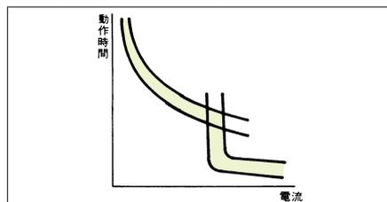
動作機構上、熱動動作(時延引外し)領域と電磁動作(瞬時引外し)領域の和で表されます。
