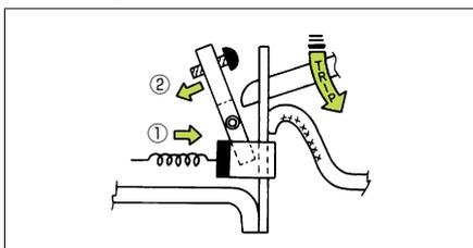
①大電流が流れる際に、発生する磁界により可動鉄心と固定鉄心が吸引し合います。②この時可動鉄心が作動板を押し開閉機構部の係合端が外れ、これに連動し可動接点が開き回路を遮断します。
