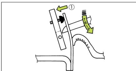
定格電流以上の電流が流れた場合、バイメタルが加熱され、わん曲し①バイメタルの先端が作動板を押し開閉機構部の係合端が外れます。これに連動し可動接点が開き、回路を遮断します。
