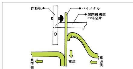
構造は図のようになっております。電流は、電源側からバイメタル、負荷側へと流れます。
