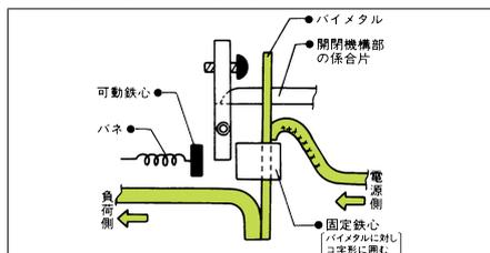
構造は図のようになっており電磁引外し素子の動作する電流値未満では、熱動式と全く同じ動作をします。
