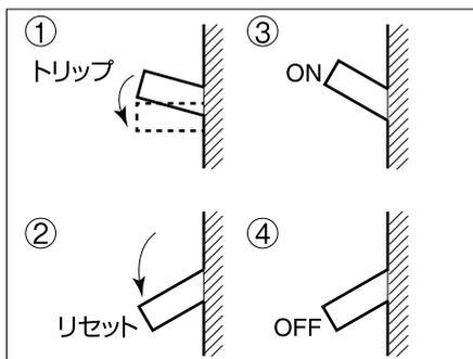
■動作(トリップ)した後で再投入する場合は、動作した原因を取り除いて安全を確認してからONの操作を行ってください。
