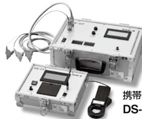
携帯型地絡点探査信号発生器
