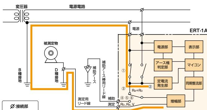
①測定用リード線を被測定物のD種接地線に接続すると、アース極判定部が電源電路のB種接地線側を判定し内部リードリレーで定電流発生部とこのB種接地線側を自動的に接続します。
