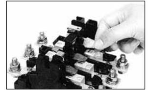
可動接点は少し回転させますとはずれます。固定接点はドライバーで取り外してください。
