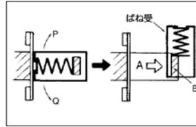
ばね受は指またはドライバーでPまたはQ方向に回転させ、ばね受を矢印A方向から力を加えB部に接するようにしてください。
