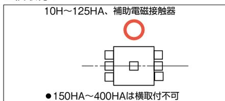
■ 150HA以上は可動コアの重量が解放動作に影響します。動作不良、遮断能力低下を招きますので横取付けはできません。横取付けの場合約20%寿命が短くなります。ご注意ください。
