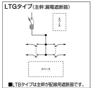
**単3** 主幹：単3中性線欠相保護付 漏電遮断器・配線用遮断器 送りスペース付 下部スペース(500mm)付
