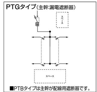
**3相** 主幹：漏電遮断器・配線用遮断器 送りスペース付 下部スペース(500mm)付
