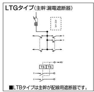
**単3** 主幹：単3中性線欠相保護付 漏電遮断器・配線用遮断器 送りスペース付 自動点滅回路(×2)付 タイムスイッチ付
