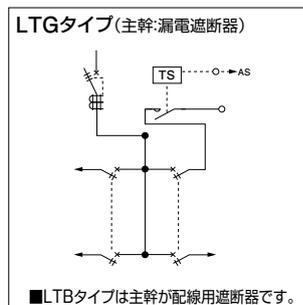
**単3** 主幹：単3中性線欠相保護付 漏電遮断器・配線用遮断器 自動点滅回路付 タイムスイッチ付 (※送りスペースなし)
