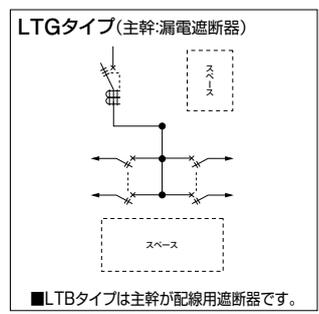
**単3** 主幹：単3中性線欠相保護付 漏電遮断器・配線用遮断器 送りスペース付 下部スペース(600mm)付
