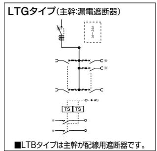
**単3** 主幹：単3中性線欠相保護付 漏電遮断器・配線用遮断器 送りスペース付 自動点滅回路(×2)付 タイムスイッチ(×2)付
