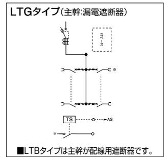
**単3** 主幹：単3中性線欠相保護付 漏電遮断器・配線用遮断器 送りスペース付 自動点滅回路付 タイムスイッチ付
