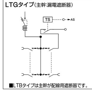
**単3** 主幹：単3中性線欠相保護付 漏電遮断器・配線用遮断器 自動点滅回路付 タイムスイッチ付 (※送りスペースなし)
