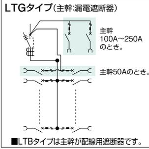
**単3** 主幹：単3中性線欠相保護付 漏電遮断器・配線用遮断器 非常回路(×2)付
