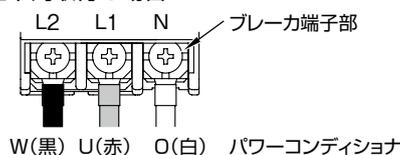
(注1)内線規程JEAC8001資料3-5-6の「逆接続可能型」です。太陽光発電システム用など系統連系用途の場合は、電源側(図の上側)に商用電源側を、負荷側(図の下側)に発電システム側を接続してください。用途にかかわらず、負荷側(図の下側)に商用電源側を接続しないでください。
