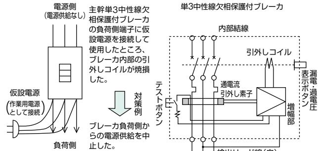
(b) 端子ねじ締付け不具合による、ブレーカが焼損した例
