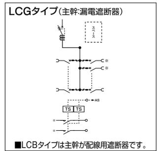
**単3** 主幹：単3中性線欠相保護付 漏電遮断器・配線用遮断器 送りスペース付 自動点滅回路(単独×2)付 タイムスイッチ(×2)付
