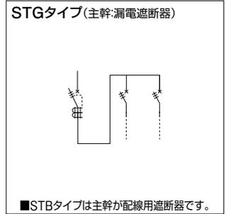
主幹：漏電遮断器・配線用遮断器 分岐：配線用遮断器×2 (屋外用)
