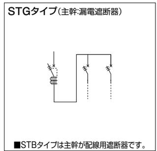
主幹：漏電遮断器・配線用遮断器 分岐：配線用遮断器×2 (屋内用)
