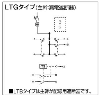
**単3** 主幹：単3中性線欠相保護付 漏電遮断器・配線用遮断器 送りスペース付 自動点滅回路(×2)付 タイムスイッチ付
