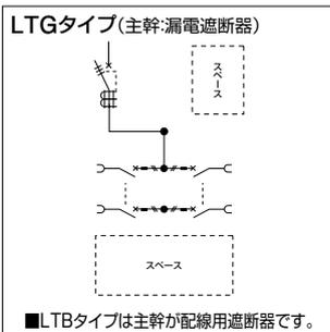
**単3** 主幹：単3中性線欠相保護付 漏電遮断器・配線用遮断器 送りスペース付 下部スペース(300mm)付
