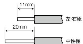
中性極は端子奥まで電線を差し込み、2本の端子ねじを、交互に2回以上確実に締付けてください。
