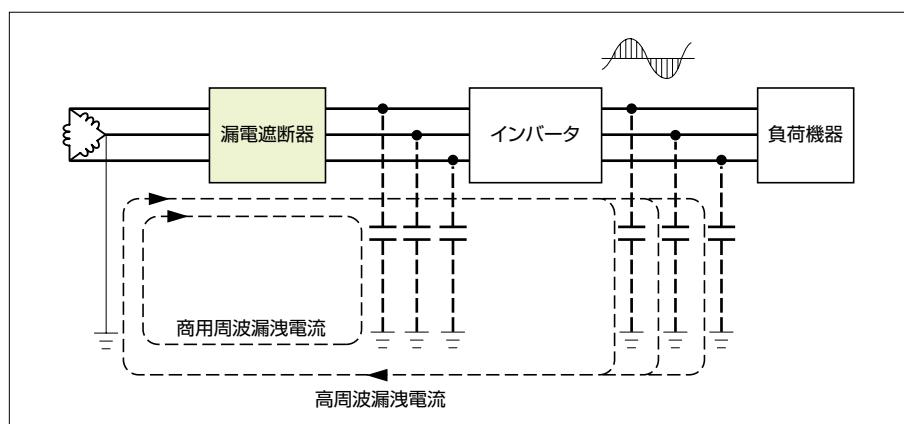
ノイズフィルタが組み込まれている場合は、電路と対地間にノイズ吸収用コンデンサがあり、このコンデンサに流れる商用周波漏洩電流および低次の高調波漏洩電流は「高調波対応形」漏電遮断器であっても漏電として検知するため、感度の鈍いもの(100/200/500mAなど)を選定してください。インバータ照明器具の漏洩電流は、1mA以下(注)に規定されておりますが、複数の照明器具が負荷となる場合はその総和になります。
