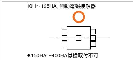
150HA以上は可動コアの重量が解放動作に影響します。動作不良、遮断能力低下を招きますので横取付けはできません。横取付けの場合約20%寿命が短くなります。また、可逆形は全器種横取付けできません。ご注意ください。
