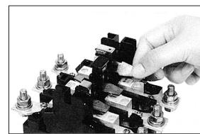
可動接点は少し回転させますとはずれます。固定接点はドライバーで取外してください。
