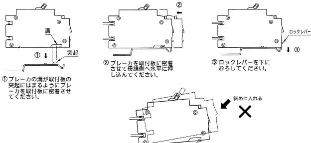
【注意】ブレーカの溝に取付板の突起がはまっていない状態でブレーカを取り付けると、ブレーカが破損するおそれがあります。
