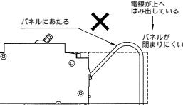
【注意】たくりをとらずに配線すると、速結端子に電線を挿入しにくく、またブレーカを破損するおそれがあります。
