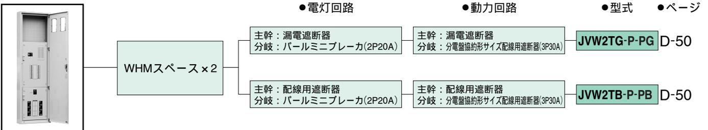
電灯回路の主幹の漏電遮断器、配線用遮断器は単3中性線欠相保護付です。
