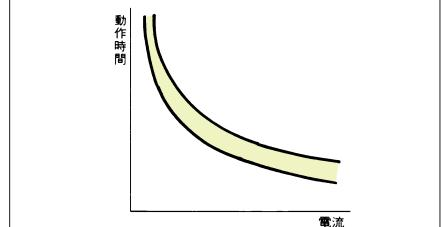
電流が大きければ、発熱量も多く、早くわん曲します。動作特性は図のように電流が増せば動作が早くなる反限時特性をもっています。
