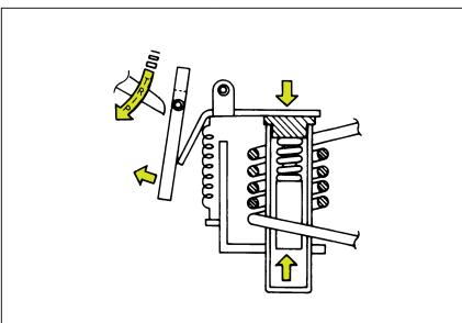
過電流がコイルに流れると可動鉄心が固定鉄心の方へ吸引されます。吸引されると磁気抵抗が減少し作動鉄片が吸引され作動板を動かし開閉機構部の係合端が外れ、これに連動し可動接点が開き回路を遮断します。
