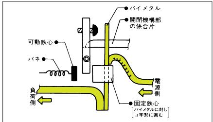
構造は図のようになっており電磁引外し素子の動作する電流値未満では、熱動式と全く同じ動作をします。
