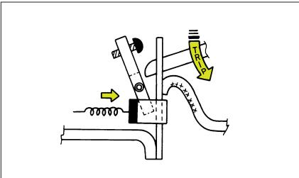
大電流が流れる際に、発生する磁界により可動鉄心と固定鉄心が吸引し合います。この時可動鉄心が作動板を押し開閉機構部の係合端が外れ、これに連動し可動接点が開き回路を遮断します。
