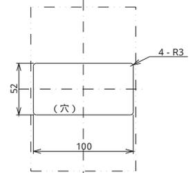
表板の高さは遮断器の底面より68mmの場合です。寸法は遮断器の窓枠に対して片側1mmの隙間をもたせた場合です。
