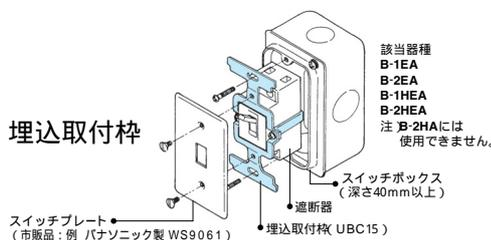
埋込取付枠は安全ブレーカをスイッチボックス(深形)に組込む場合に使用します。その場合プレートは、埋込タンブラスイッチプレートとボックスをお求めください。
