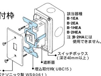
埋込取付枠は安全ブレーカをスイッチボックス(深形)に組込む場合に使用します。その場合プレートは、埋込タンブラスイッチプレートとボックスをお求めください。市販品 埋込タンブラスイッチプレートとボックス等
