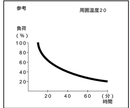
バッテリーのバックアップ時間は定格出力時において約10分間ですが負荷率が下がりますとバックアップ時間は長くなります。
