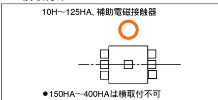
150HA以上は可動コアの重量が解放動作に影響します。動作不良、遮断能力低下を招きますので横取付けはできません。横取付けの場合約20%寿命が短くなります。また、可逆形は全器種横取付けできません。ご注意ください。
