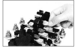
可動接点は少し回転させますとはずれます。固定接点はドライバーで取外してください。
