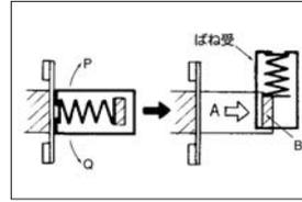
ばね受は指またはドライバーでPまたはQ方向に回転させ、ばね受を矢印A方向から力を加えB部に接するようにしてください。
