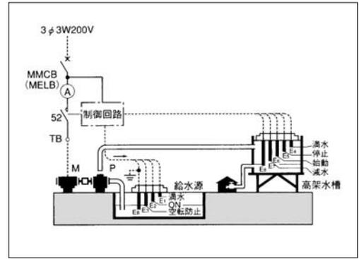
3 3W 200V 給水源の水位表示と減水によるポンプの空転防止、
