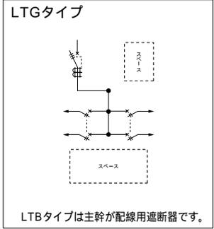
**単3** 主幹：単3中性線欠相保護付 漏電遮断器・配線用遮断器 送りスペース付 下部スペース(500mm)付
