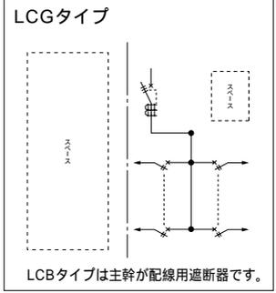
**単3** 主幹：単3中性線欠相保護付 漏電遮断器・配線用遮断器 送りスペース付 動力スペース付
