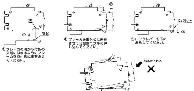
注意: ブレーカの溝に取付け板の突起がはまっていない状態でブレーカを取り付けると、ブレーカが破損するおそれがあります。
