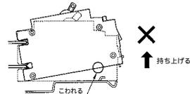
注意: スライドさせずにブレーカの負荷側を無理に持ち上げるとブレーカが破損します。
