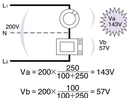
GBU(単3中性線欠相保護付漏電遮断器)は135V以上の過電圧で1秒以内に遮断しますので負荷機器を過電圧事故から確実に保護します。テンパールの住宅用分電盤は、この単3中性線欠相保護付漏電遮断器が標準組込です。(但し単2の分電盤は除く)また、テンパールの単3中性線欠相保護付漏電遮断器は全日本電気工業工業組合連合会の推奨品です。
