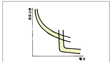
動作機構上、熱動動作(時延引外し)領域と電磁動作(瞬時引外し)領域の和で表されます。
