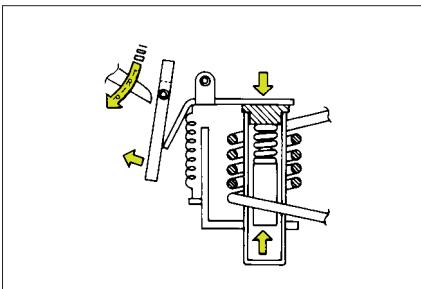
過電流がコイルに流れますと可動鉄心が固定鉄心の方へ吸引されます。吸引されると磁気抵抗が減少し作動鉄片が吸引され作動板を動かし開閉機構部の係合端が外れ、これに運動し可動接点が開き回路を遮断します。
