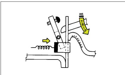
大電流が流れる際に、発生する磁界により可動鉄心と固定鉄心が吸引し合います。この時可動鉄心が作動板を押し開閉機構部の係合端が外れ、これに運動し可動接点が開き回路を遮断します。
