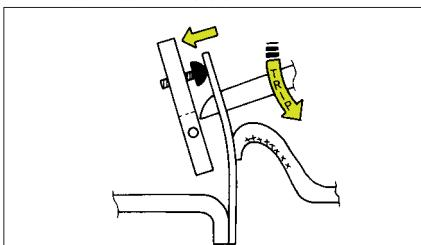
定格電流以上の電流が流れた場合、バイメタルが加熱され、わん曲しバイメタルの先端が作動板を押し開閉機構部の係合端が外れます。これに運動し可動接点が開き、回路を遮断します。
