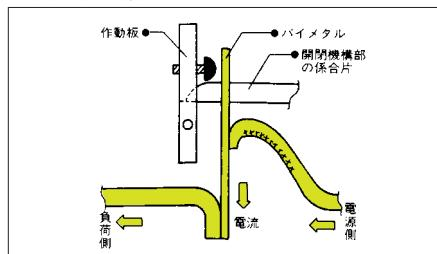
構造は図のようになってあります。電流は、電源側からバイメタル、負荷側へと流れます。
