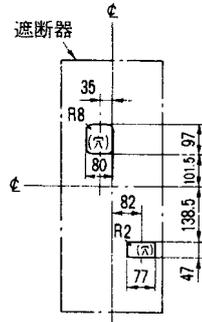
寸法は遮断器の窓枠に対して片側1mmのすき間をもたせた場合です。
