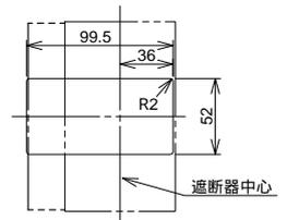
(遮断器の窓枠に対して片側1mmのすき間をもたせた場合です。)
