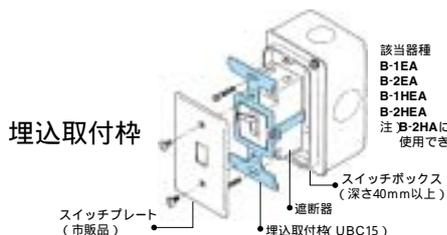
埋込取付枠は安全ブレーカをスイッチボックス(深形)に組込む場合に使用します。その場合プレートは、埋込タンブラスイッチプレートとボックスをお求めください。
