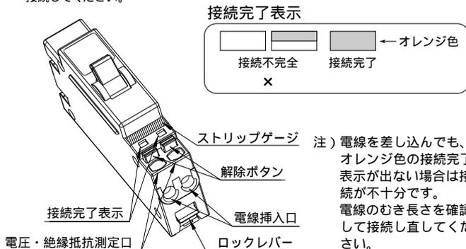
注) 電線を差し込んでも、オレンジ色の接続完了表示が出ない場合は接続が不十分です。電線のむき長さを確認して接続し直してください。
