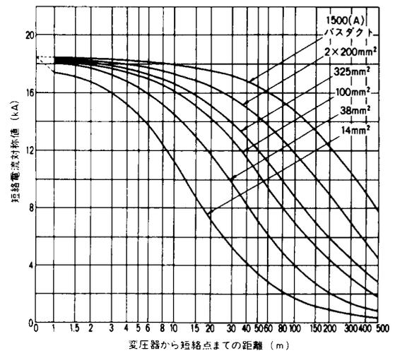
付図16 三相変圧器容量750kVA、二次電圧200V
