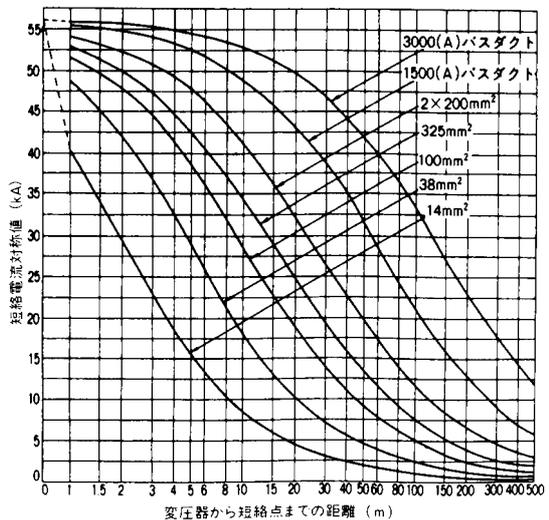
付図17 三相変圧器容量750kVA、二次電圧415V
