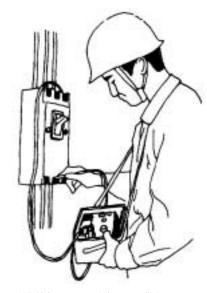
活線状態で漏電遮断器の感度テスト、 動作時間テスト及び漏電火災警報器の 感度テストをする測定器です。
