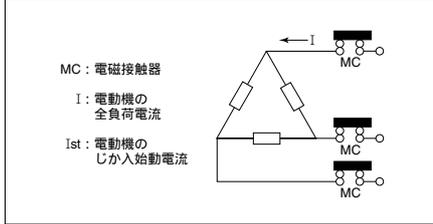
始動時、電動機全負荷電流の5～6倍の始動電流が流れますのでこの電流を開閉できる接触器、AC3級 定格電流の10倍の使用電流を開閉でき、8倍の電流を遮断できる接触器を用います。
