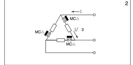
電動機が加速してから閉路し、かつ相電流を開閉すればよいので、電磁接触器はじか入始動の1/3倍(約0.6倍)の容量でよい。
