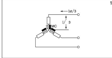
始動電流がじか入れに比べ1/3であり、スターの運転時間は短時間のため、電磁接触器はじか入れの1/3倍の容量でよい。
