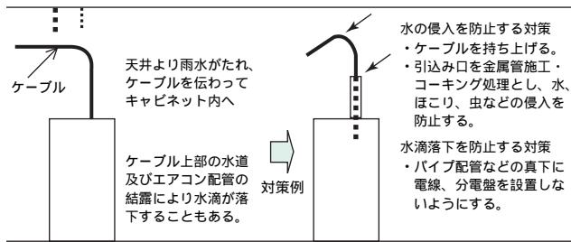
(b)屋外(屋側)に設置したキャビネットに雨水が侵入し、事故に至った例。
