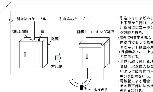
(c)引込み線コネクタ部分からより線の内部に雨水が侵入し、スイッチ内部に浸水し事故に至った例。
