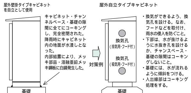
(b)キャビネット下部への浸水が原因で発生する結露による事故
